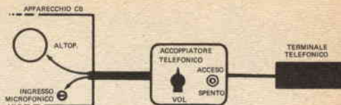
Fig. 2 - Schema delle connessioni di un accoppiatore telefonico alla stazione CB fissa.
